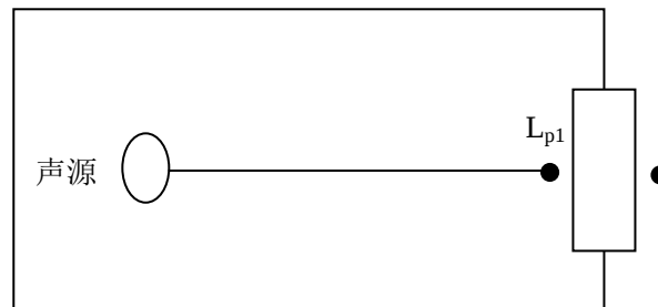
图 6.3-1 室内声源等效为室外声源图例
