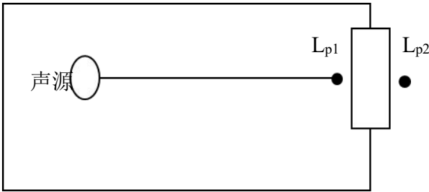
图 4-1 室内声源等效为室外声源图例
